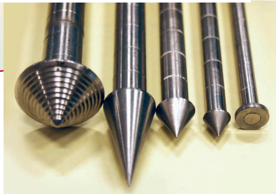
Figuur 1 – Voorbeelden van penetrometers, met verschillen in ruwheid, tophoek en diameter van de conus.
