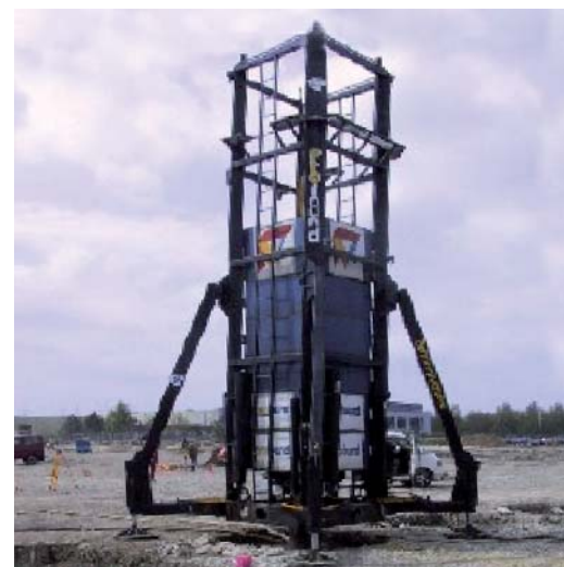
Figuur 5 Statnamic proefbelasten.
