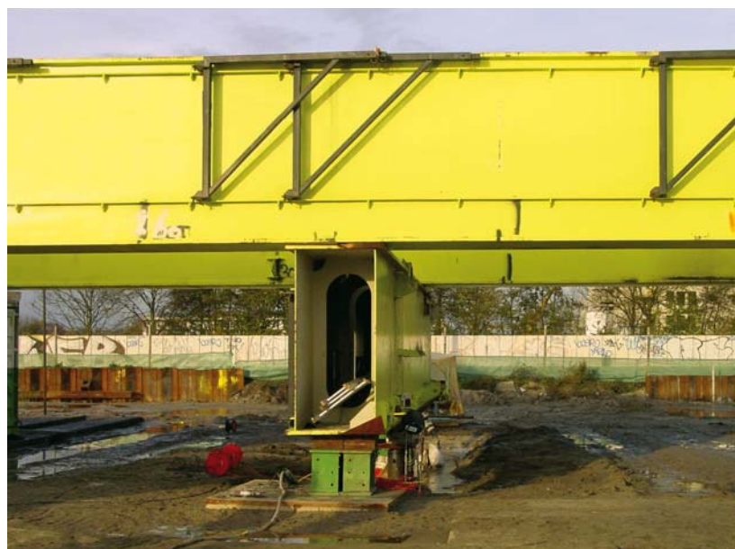
Uitvoeren proefbelasting met reactieframe.
