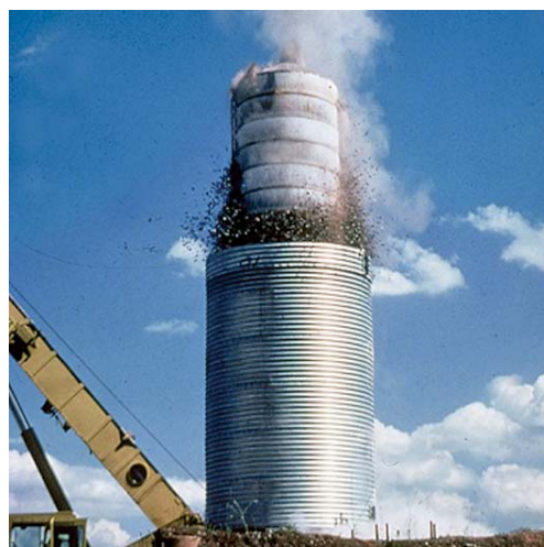
Figuur 2 Statnamic proefbelasting met een grindcontainer als opvangmechanisme
