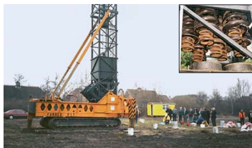
Figuur 1 Pseudo Static Pile Load Tester met een stalen verenpakket
