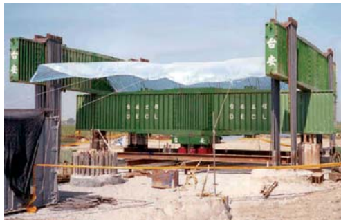
Figuur 9 Een 50 MN reactieframe voor statisch proefbelasten
