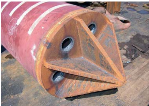
Figuur 6 Gedeeltelijk open paalpunt
