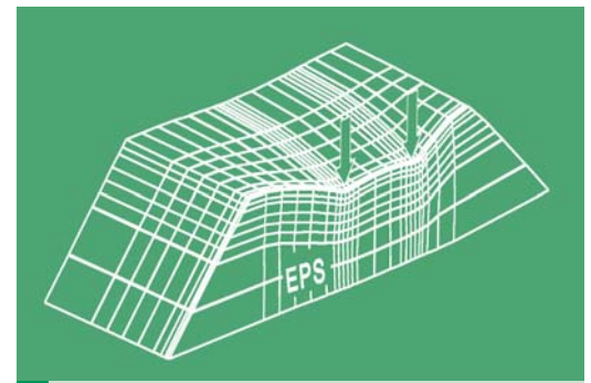
Figuur 1 Driedimensionaal verhardingsmodel berekend met het CAPA-3D programma
