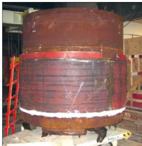
↑ Figuur 6 Het eerste segment van een paal (conus) en het graafwiel is onder de conus zichtbaar
