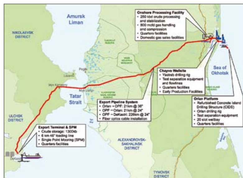
← Figuur 1 Een overzicht van de infrastructuur die binnen het Sakhalin-1 project is ontwikkeld. De SPM is het eindpunt van een route die de aan de oostkust van Sakhalin gewonnen olie over ongeveer 250 km naar het vasteland van Rusland en uiteindelijk naar de baai bij De-Kastri voert.
