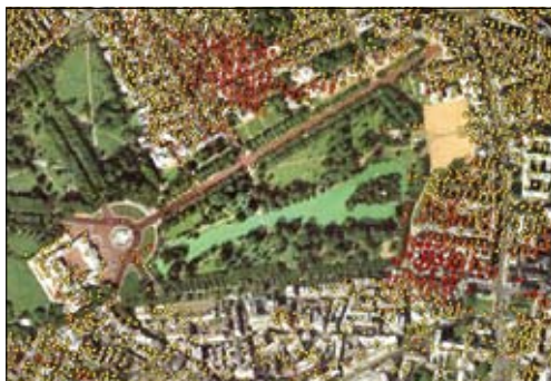
↑ Figuur 1 Een voorbeeld van een SAR-toepassing (Synthetic Aperture Radar) voor de detectie van bodemdaling (rode bolletjes) in een deel van London ten gevolge van de aanleg van een nieuwe metrolijn (met toestemming van Vexcel Corporation, a Microsoft company www.vexcel.com )
