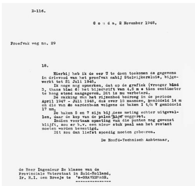
Figuur 3 – Memo november 1948 betreffende aantasting koppen meetpunten door rot.
