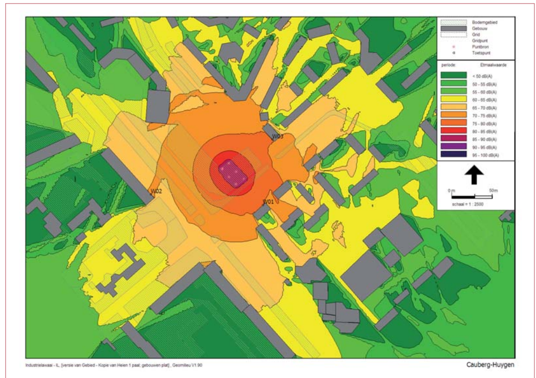
Figuur 3 – De geluidbelasting ten gevolge van het heien berekend met een akoestisch rekenmodel.
