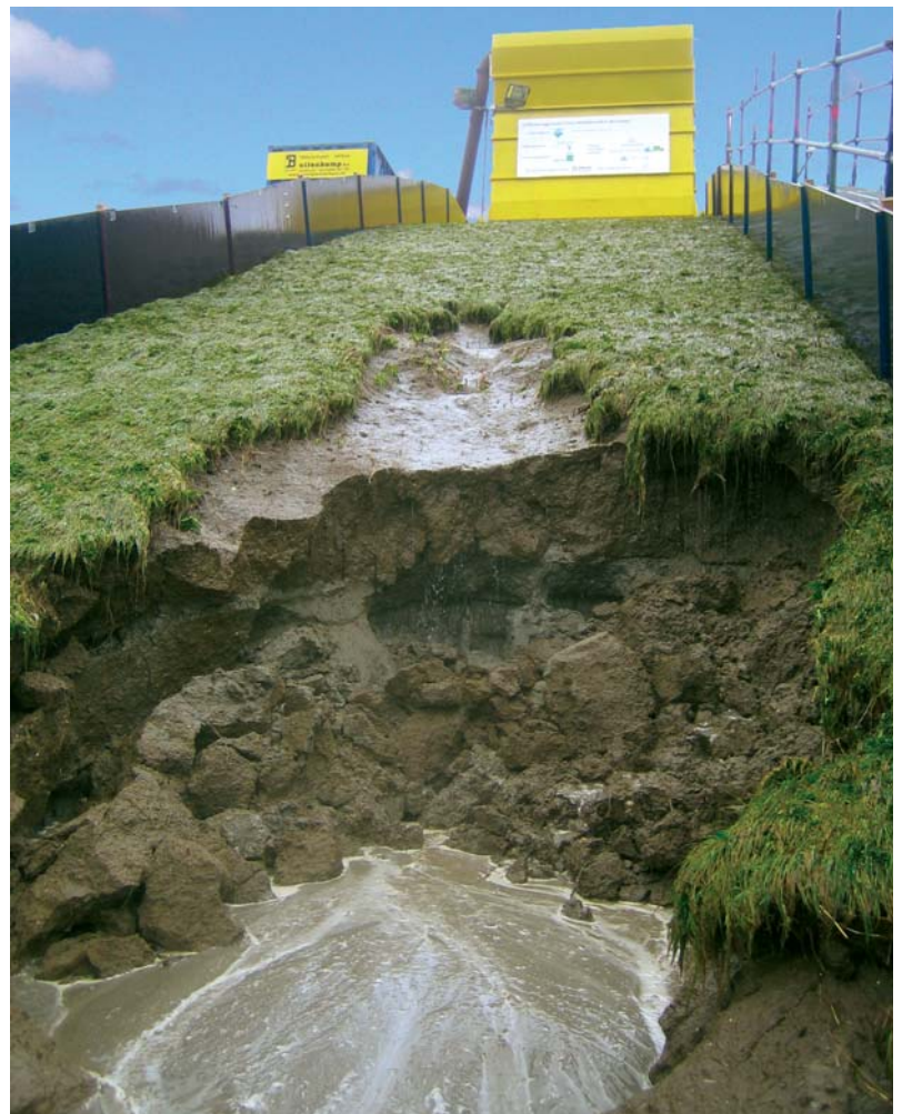
Figuur 3 Het resultaat na 75 l/s per m: De zandkern is blootgelegd na het eroderen van de met gras beklede kleilaag en spoelt weg.
