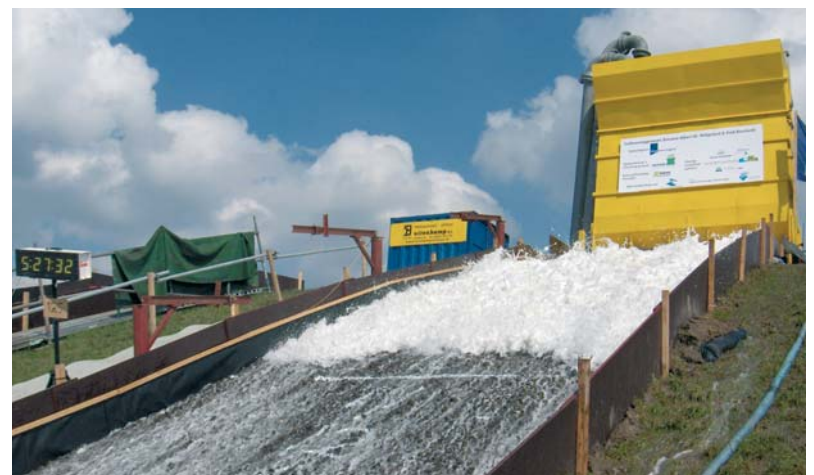
Figuur 5 Een overslagproef is uitgevoerd met Elastocoast, waarbij het materiaal overslagvolumes van 125 \text{ l s}^{-1} \text{ m}^{-1} doorstond, met stroomsnelheden van 6-12 \text{ m s}^{-1} .
