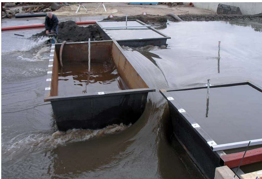
Figuur 7 Foto: Waterstromingen bij geforceerd verschuiven BoxBarrier op asfalt.
