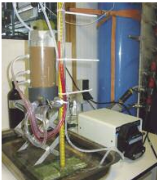
Figuur 2 - Foto doorlatendheidsopstelling en detail RVS plaat met geotextiel.
