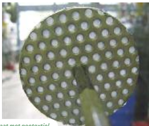
Figuur 2 - Foto doorlatendheidsopstelling en detail RVS plaat met geotextiel.
