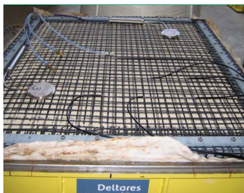
Figuur 1 - Belastingverdeling in een paalmatras.
