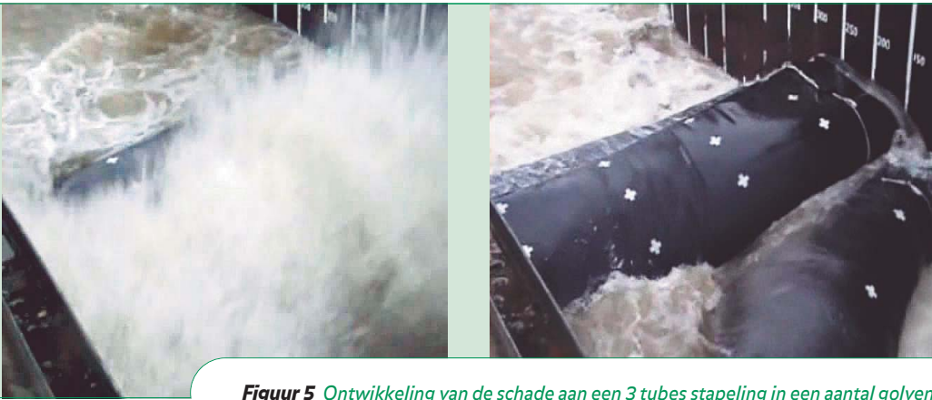
Figuur 5 Ontwikkeling van de schade aan een 3 tubes stapeling in een aantal golven.
